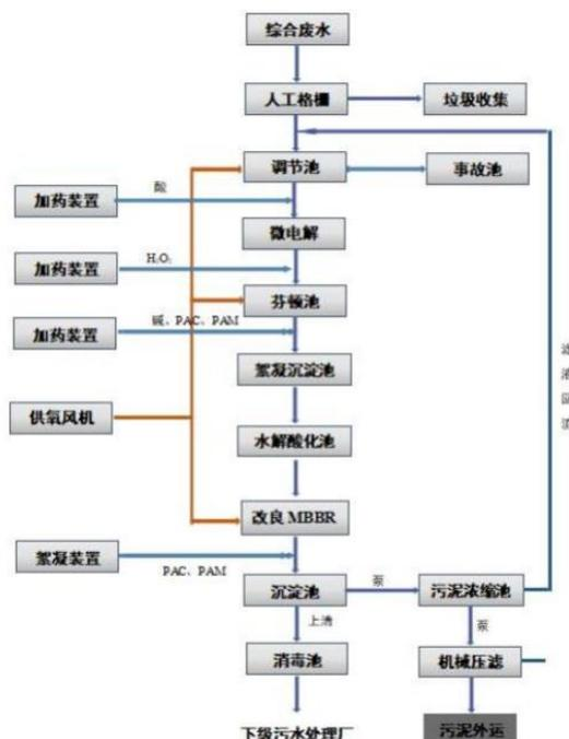
图 4-1 园区污水处理站工艺流程图
