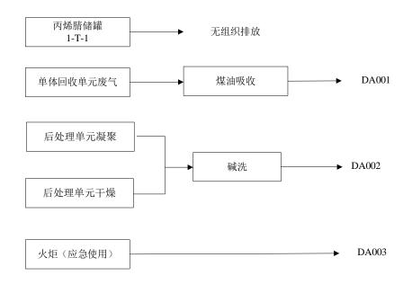
图 2.3-1 验收时废气处理措施流程示意图
