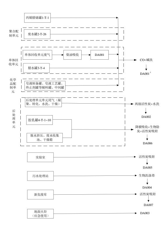
图 2.3-2 验收变动后废气处理流程示意图
