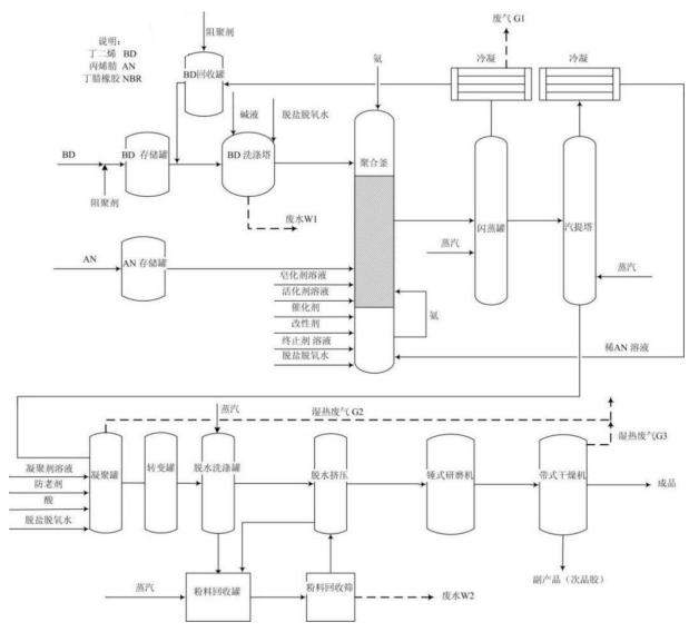
图 2.2-1 丁腈橡胶工艺流程图
